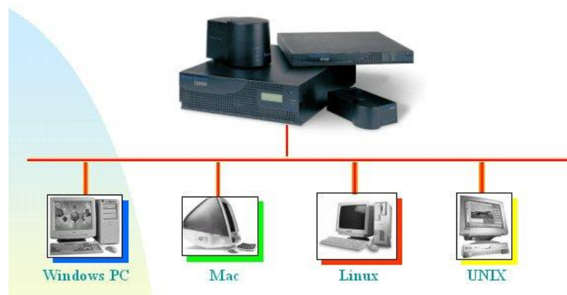
Figura 36. Las unidades NAS se conectan directamente a la LAN y son accesibles a los clientes y servidores en ella.
