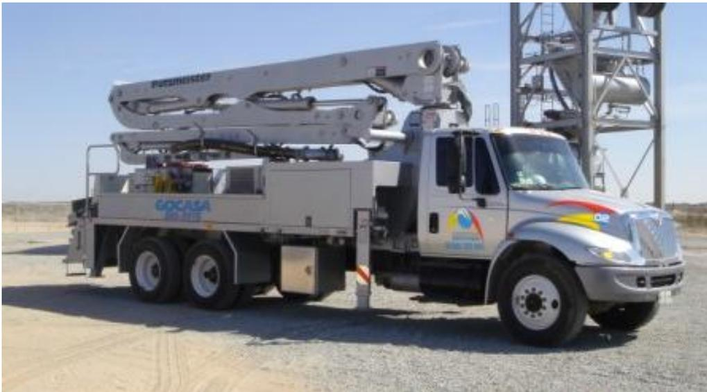
***Bomba de concreto sobre camión.***
