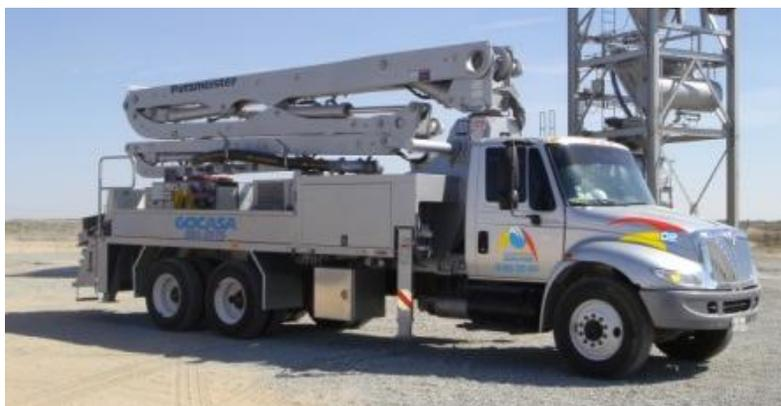
**Bomba de concreto sobre camión.**
