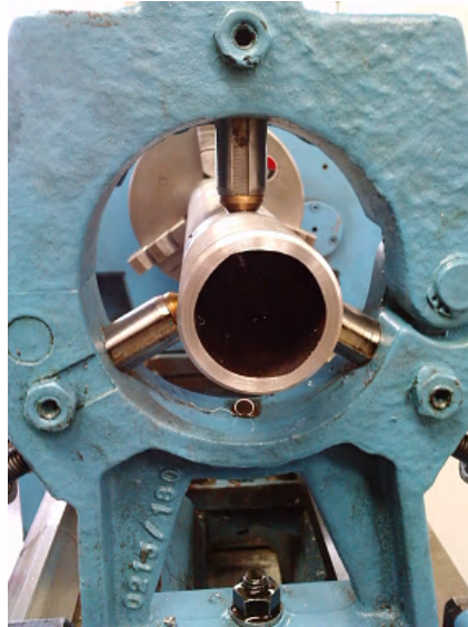
Figura 19. Maquinado de la parte media de la flecha rotatoria.
