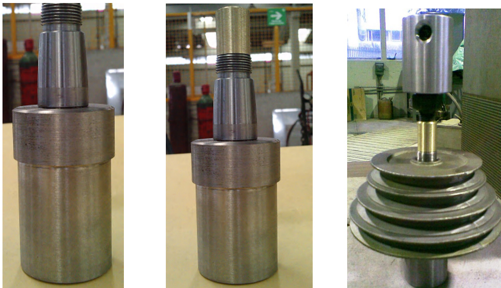
Figura 18. a) Cople de acero. b) Cople de acero unido al cople de bronce. c) Cople unido con la polea.
