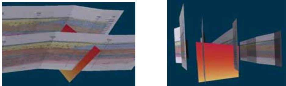
Figura 7.33 Perspectivas de una falla mayor (caso 2), la falla se manifiesta en más de una sección geológica. En este caso el plano corresponde a la falla Chapultepec.
