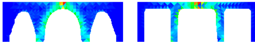
Figura 4.16: Distribución de esfuerzos para las iteraciones 2021 y 2886 en el diseño óptimo del puente
