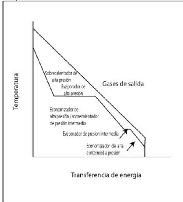
Figura 1.14 Diagrama energético de temperatura vs energía transferida, para un ciclo doble
