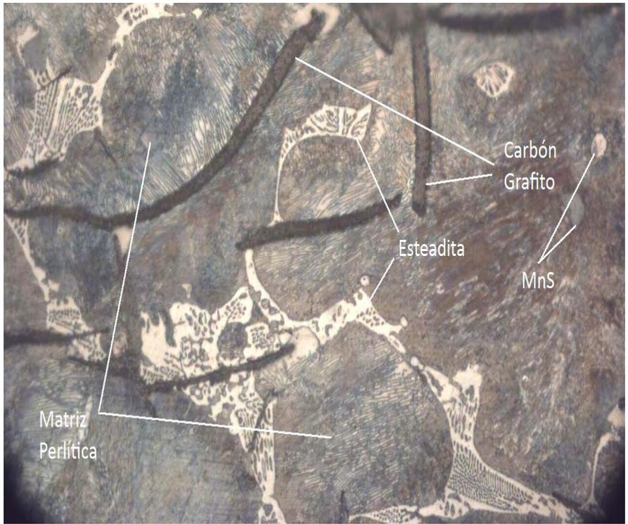
Imagen 6.1.2.2 Microestructura de la pieza. Vista a 1000X
