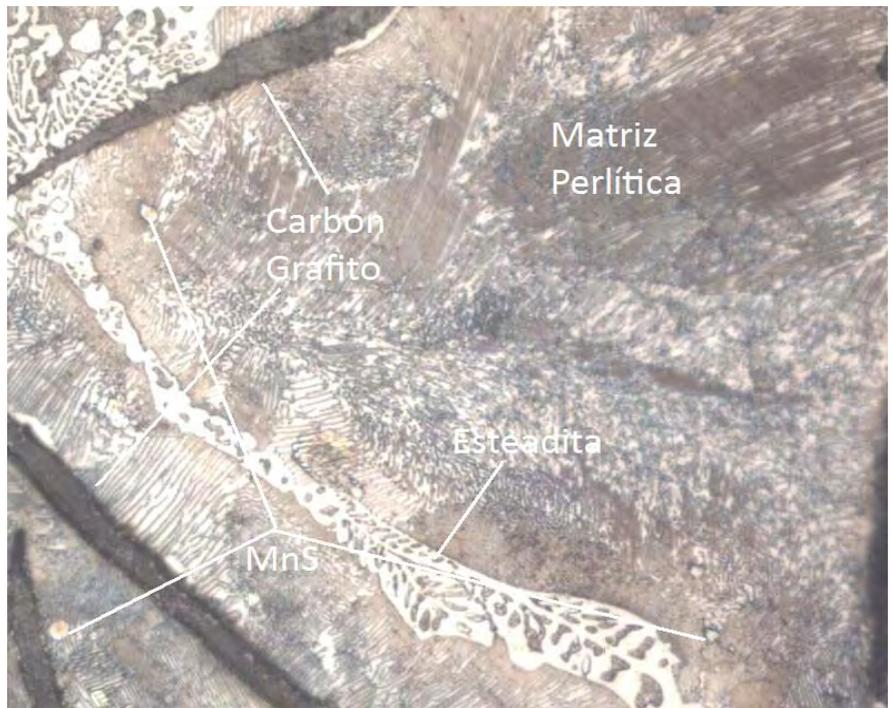
Imagen 6.1.2.3 Microestructura de la pieza. Vista a 1000X
