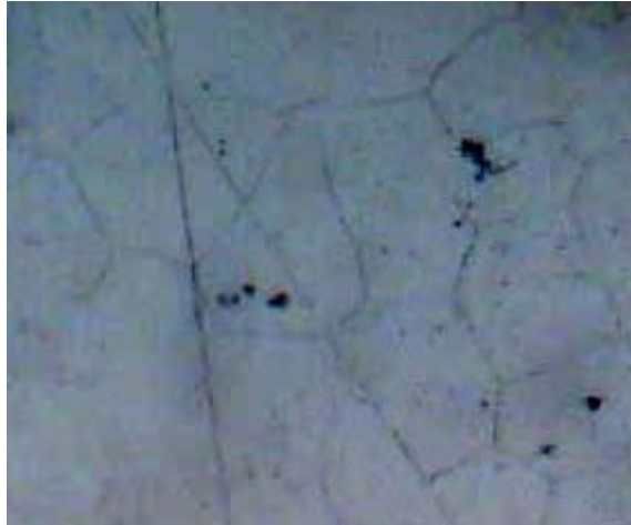
Figura 5.1: Metalografía de la pieza estudiada a 500x vista con ayuda del MEB con un ataque electroquímicamente con ácido oxálico al 10.
