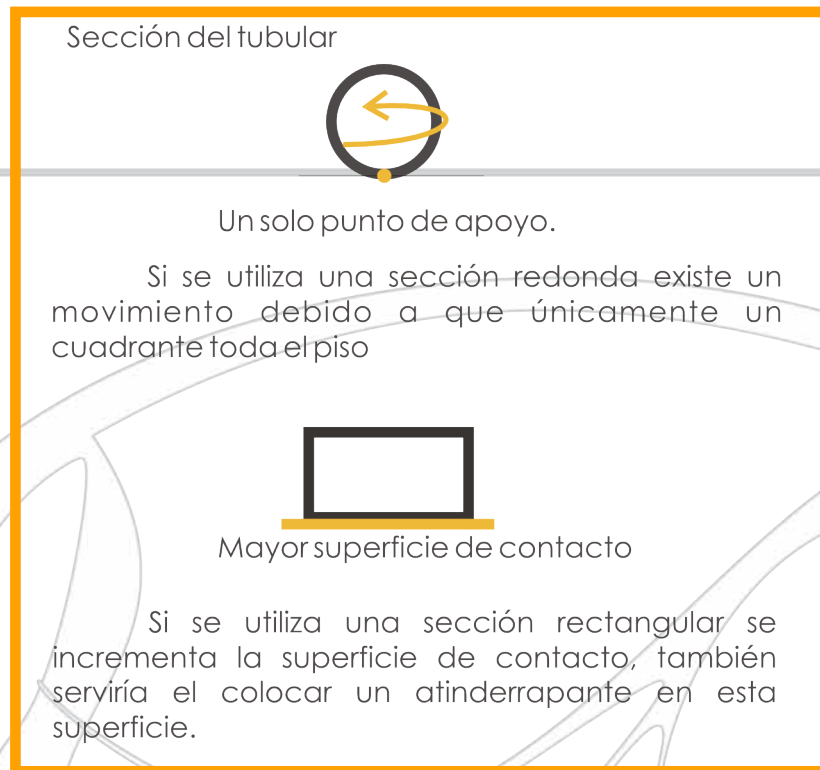
Fig. 3.14 Esquema de secciones de perfiles empleadas en el simulador
