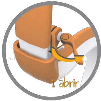
Fig. 4.9 Paso 1 para ajuste de altura
