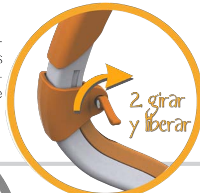
Fig. 4.10 Paso 2 para ajuste de altura
