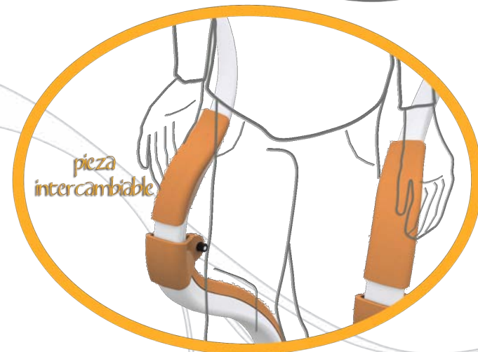
Fig. 4.22 Empuñadura. Unión de macho y hembra
