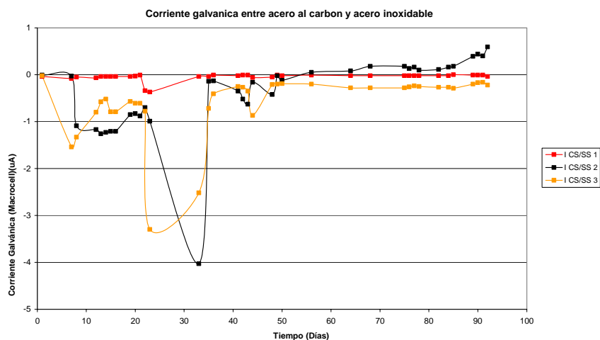
Figura 3.4 Valores de corriente galvánica entre acero al carbón y acero inoxidable en solución de \text{Ca}(\text{OH})_2
