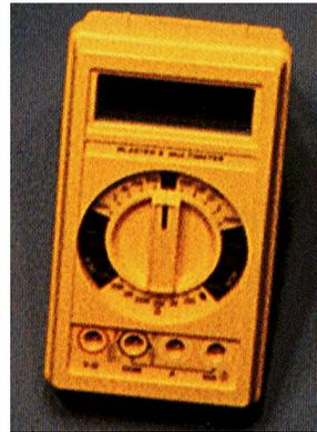
Figura III.20.- Multímetro para voladuras.
