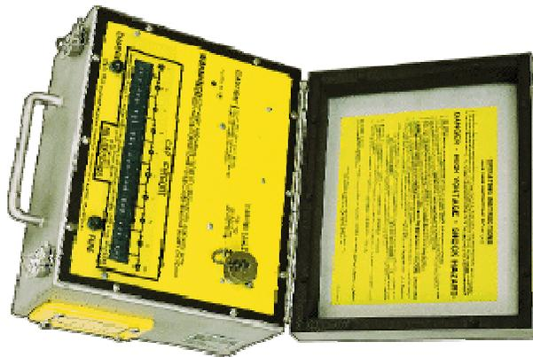
*Figura III.18.- La explosora de descarga de condensador no dispara a menos que ambos botones el de "carga" y el de "disparo" ("charge" y "fire" respectivamente) sean accionados conjuntamente.*
