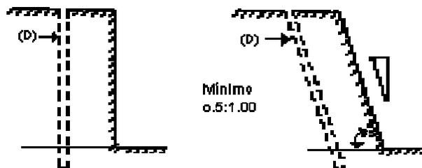
Figura IV.8.- Muestra esquemática de un frente de banco vertical y uno inclinado.
