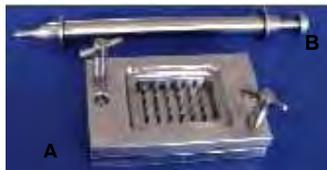
**Figura 2. Constructor de microarreglos de tejido (Numero de serie ab1802). Instrumento constituido por un molde de bloque receptor (A) y la “jeringa extractora” (B).**
