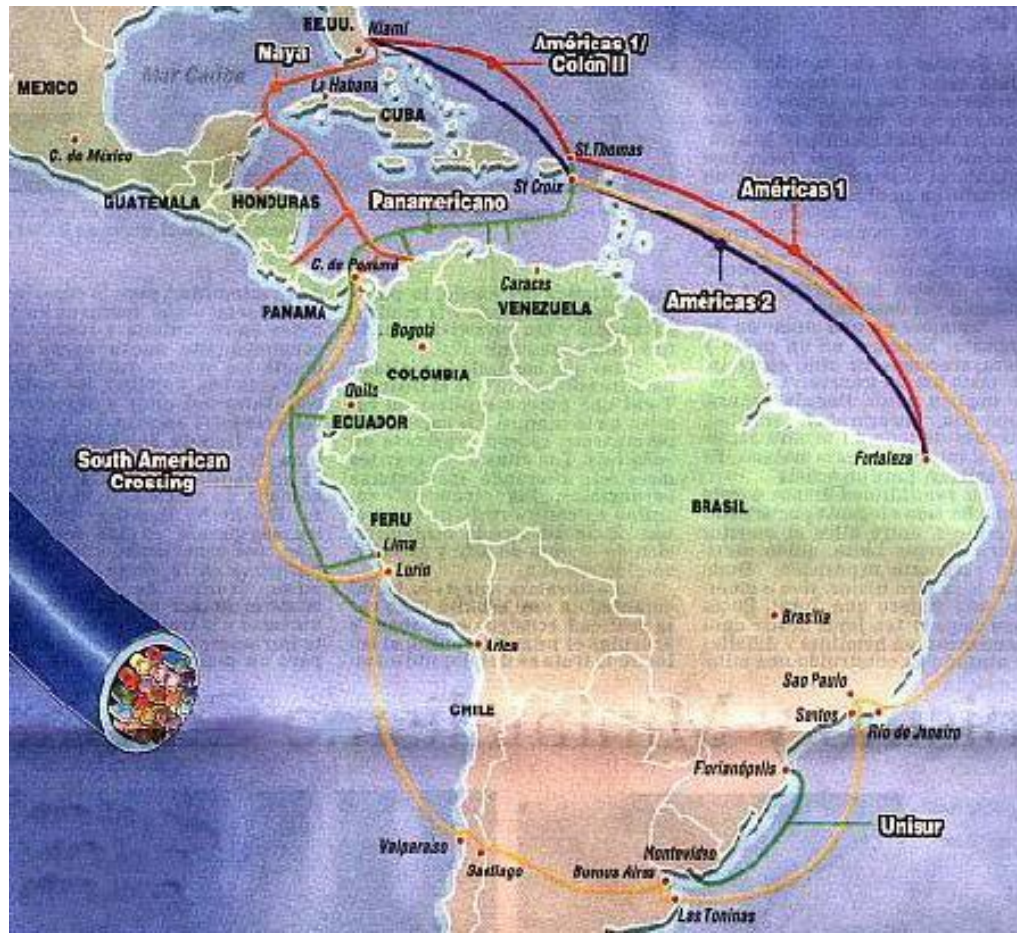
Fig. N° 2.3, Esquema de la red con Fibra Óptica en Sudamérica.
