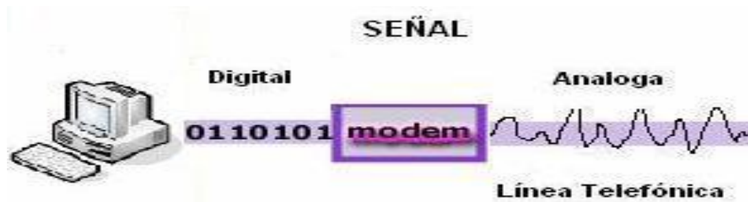
Fig. Nº 3.1, Transformación de la señal en un módem.
