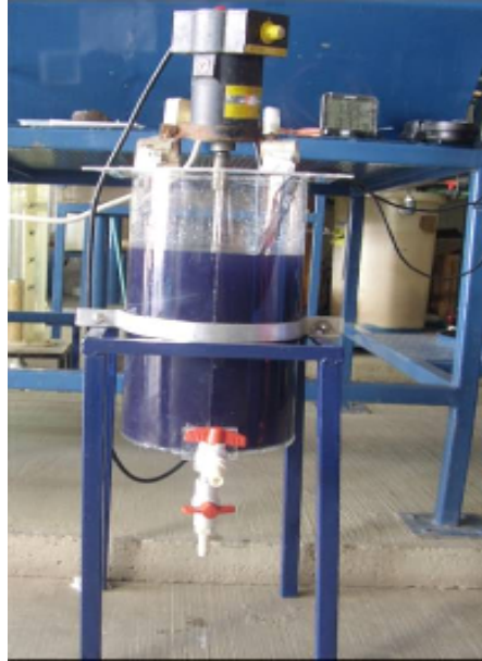
Figura 4.56 Sistema experimental para el tratamiento físico-químico del colorante azul negro directo
