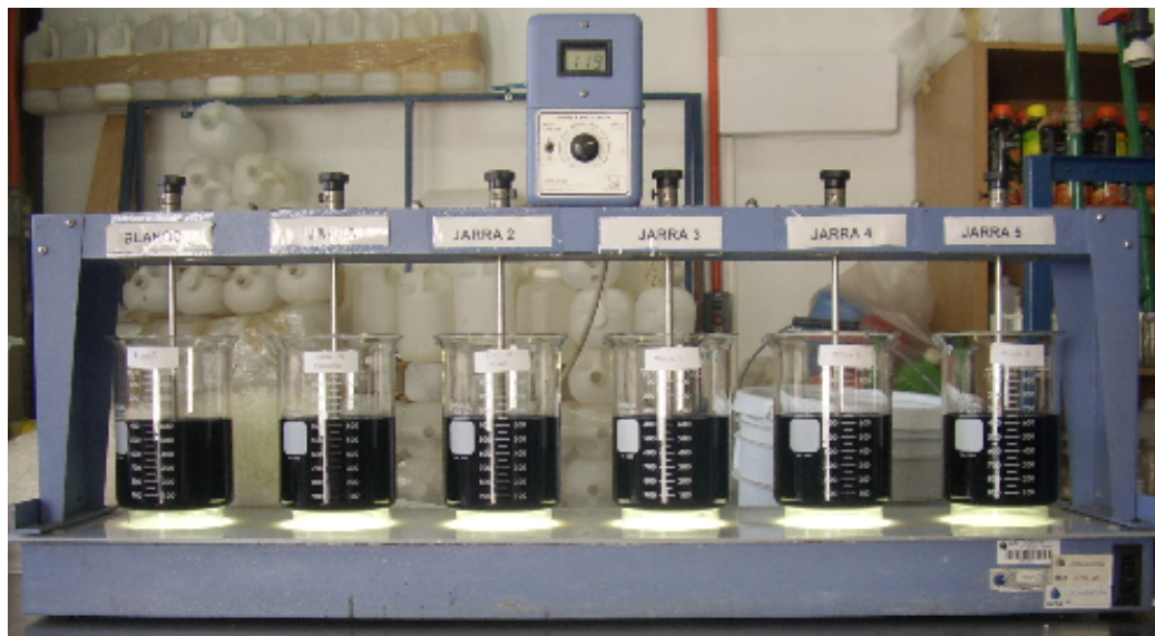
Figura 3.3. Prueba con reactores completamente mezclados utilizada durante la experimentación
