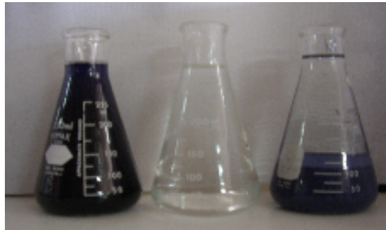
Figura 4.60. Muestras obtenidas del ciclo 24 en el tratamiento físico-químico del colorante azul negro directo
