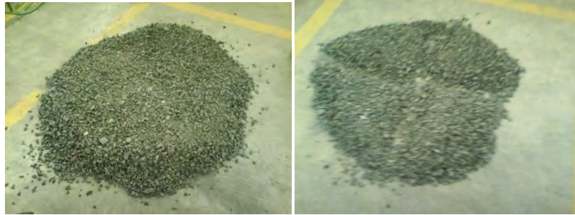
Figura 2.4.- Cuarteo del mineral.
