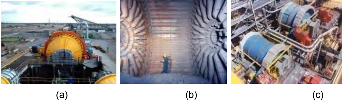
Figura 1.3.- Molinos SAG. a) Molino SAG Minera Francisco I. Madero, Zacatecas. b) Interior del molino SAG. c) Diferencia de dimensionamiento entre el molino SAG y molino de Bolas.
