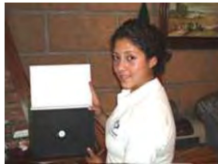
Figura 14 El agujero se ve negro a pesar de que el interior de la caja está pintado de blanco. La energía radiante que entra por la abertura tiene pocas probabilidades de salir antes de ser absorbida totalmente.
