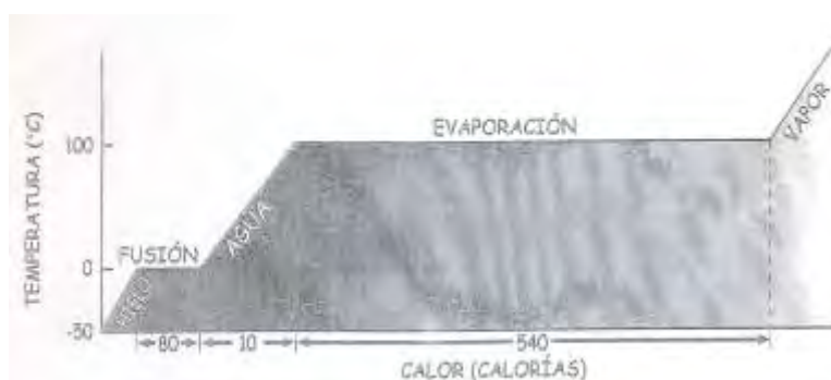
Figura 13. Gráfica que muestra la energía que interviene en el calentamiento y en los cambios de la fase de 1 gramo de H 2 O.
