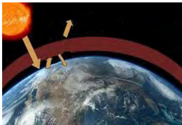
Figura 17 La atmósfera de la Tierra actúa como una especie de válvula de un solo sentido porque permite el paso de la luz visible que proviene del Sol, pero, en virtud de su contenido de vapor de agua y de dióxido de carbono, impide la salida total de la radiación terrestre.
