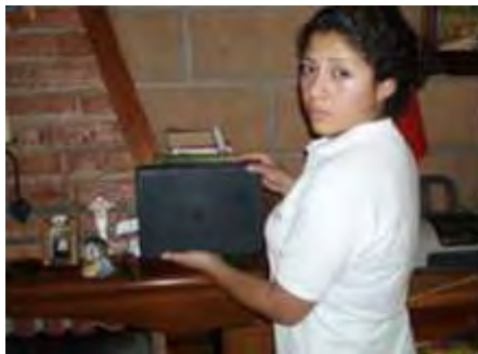
Figura 14 El agujero se ve negro a pesar de que el interior de la caja está pintado de blanco. La energía radiante que entra por la abertura tiene pocas probabilidades de salir antes de ser absorbida totalmente.
