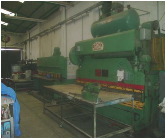
Figura 2.27. Dobladora de lámina con alimentación del centro de carga principal.
