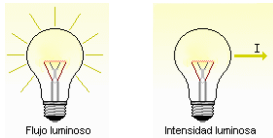
Figura III. 7 DIFERENCIA ENTRE FLUJO E INTENSIDAD LUMINOSA
