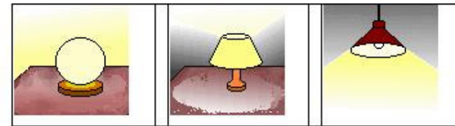
Figura III.10 INFLUENCIA DE LA LUMINARIA EN FORMA DE HAZ DE LUZ
