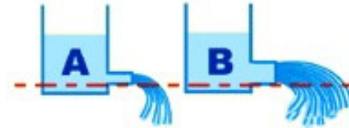
Figura III.15 ANALOGÍA HIDRÁULICA EL TUBO DEL DEPÓSITO "A", AL TENER UN DIÁMETRO REDUCIDO, OFECE MÁS RESISTENCIA A LA SALIDA DEL LÍQUIDO QUE EL TUBO DEL TANQUE "B", QUE TIENE MAYOR DIÁMETRO. POR TANTO, EL CAUDAL O CANTIDAD DE AGUA QUE SALE POR EL TUBO "B" SERÁ MAYOR QUE LA QUE SALE POR EL TUBO "A".
