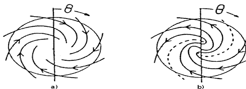
Figura 2.2: a) Un modelo de campo simétrico alrededor del eje (norte -sur) galáctico. b) Modelo bisimétrico de campo. Este último es el modelo que mejor puede reproducir las mediciones de RM
