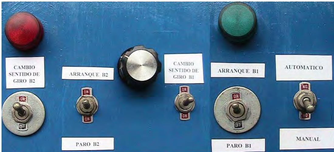
Figura 6.8 Cambio de sentido modo manual
