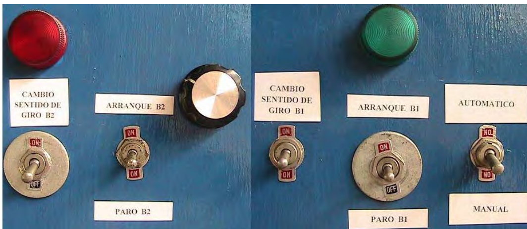
Figura 6.6 Arranque modo manual
