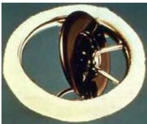
Figura 7 Válvula de Bjork-Shiley. El puntal de entrada era integral a la cubierta, mientras que el puntal de salida estaba soldado a la jaula, esta unión falló dando por resultado el escape de la valva.
