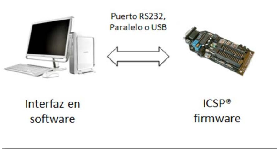
Figura 3.3. Diagrama de un programador que implementa el ICSP por *firmware*.
