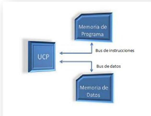
Figura 1.5. Diagrama de la Arquitectura Harvard para un microcontrolador
