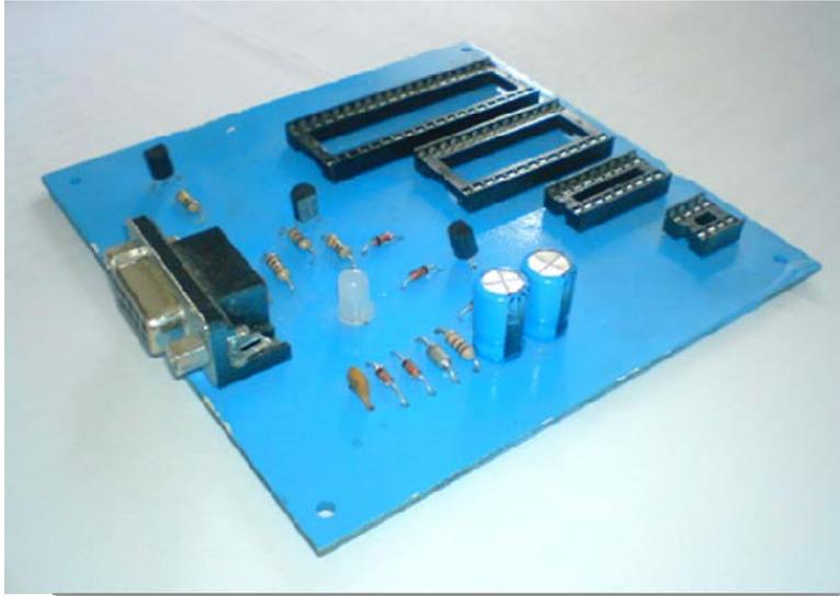
Figura 3.4. Programador LATI PIC S-1 basado en el programador JDM.
