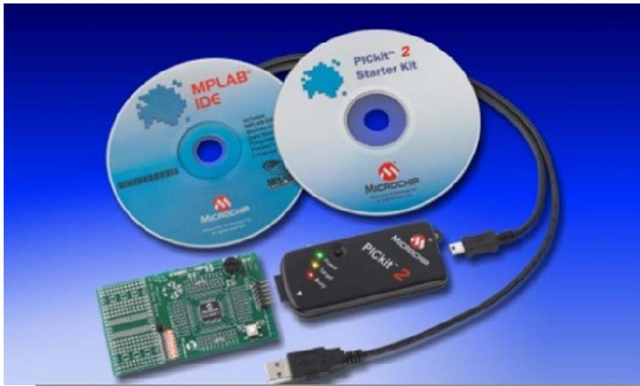
Figura 2.15. Sistema PicKit® 2 ICD *Programmer*.
