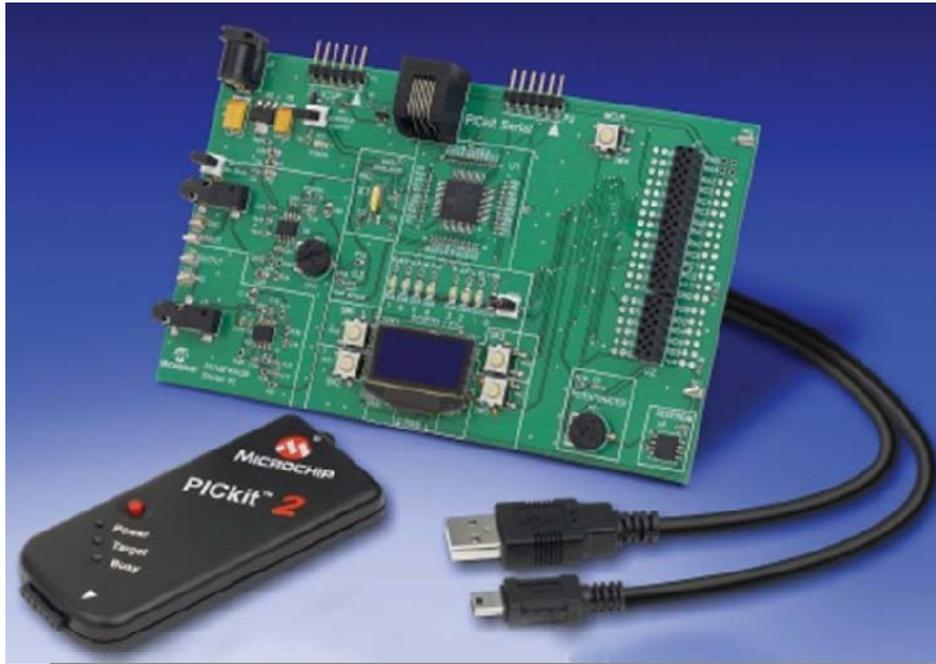
Figura 2.10. Tarjeta entrenadora PIC18F4xk20 Starter Kit.
