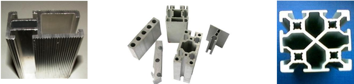
Figura 12 Ejemplos de piezas obtenidas por extrusión
