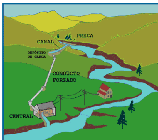
Figura I.3 Esquema de una minihidroeléctrica de “agua fluyente”
