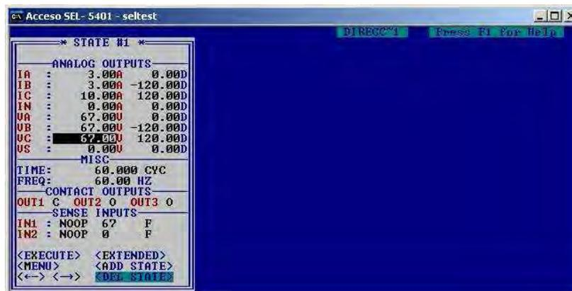
Figura 5.66 Prueba de la Protección 67
