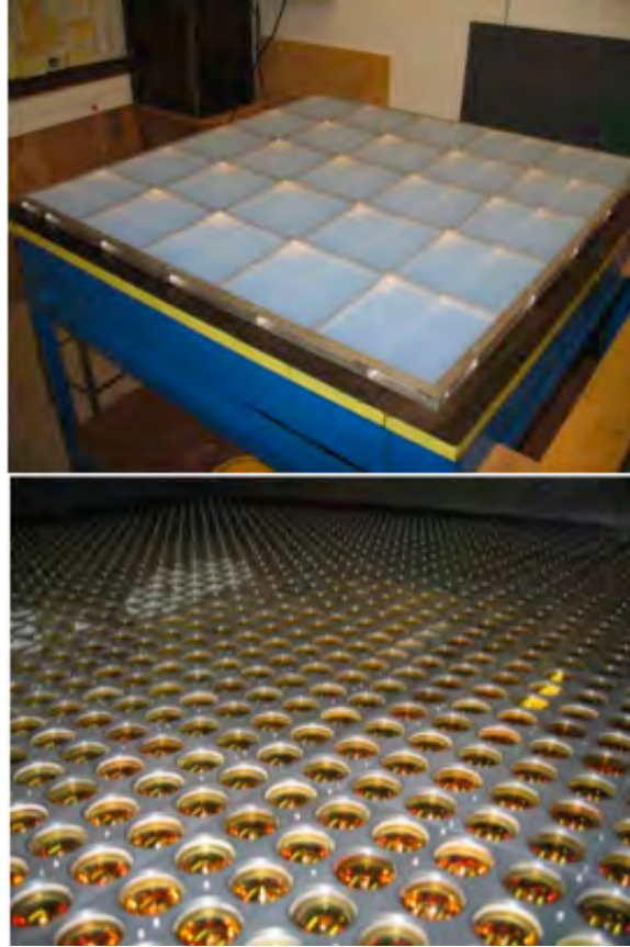
Figura 2.5: La figura de arriba muestra el plano del radiador de aerogel y la figura de abajo muestra el plano de detección del detector CherCam
