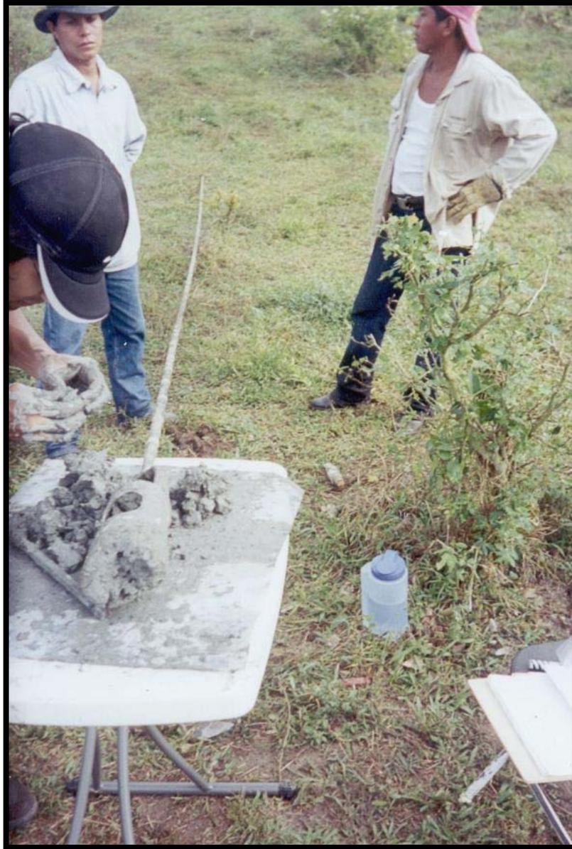
Fig.8: Revisión de las muestras obtenidas a partir de las pruebas de barreno
