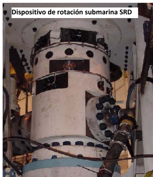
Figura 4.8. Dispositivo de rotación submarina empleado para separar el agua de mar dentro del tubo ascendente, del lodo de perforación proveniente del agujero 7
