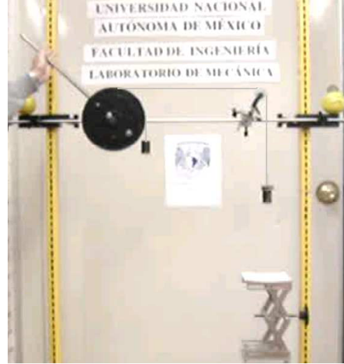
Figura 4.14 Girar continuamente (condición de inestabilidad)
