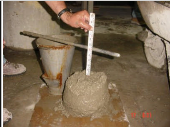
Foto 39. Prueba de revenimiento ejecutada en la planta de Cemex.
