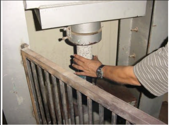
Foto 50. Prueba de compresion axial a las probetas
