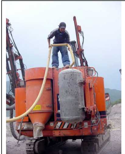
Foto 9. Mantenimiento del equipo, carga de combustibles
