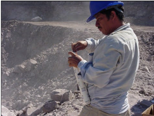
Foto 13. Introducción del fusible del iniciador en la salchicha
