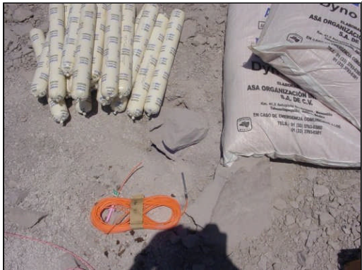
Foto 30. Un barreno listo para cargarse.
