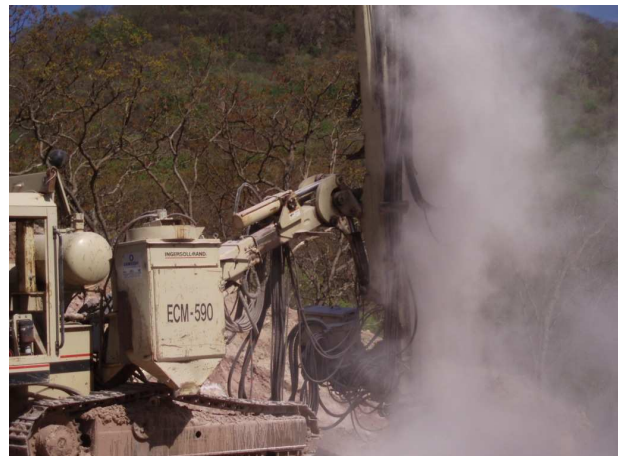
Figura V - 1 Empleo de track drill para la extracción de material para el camino
