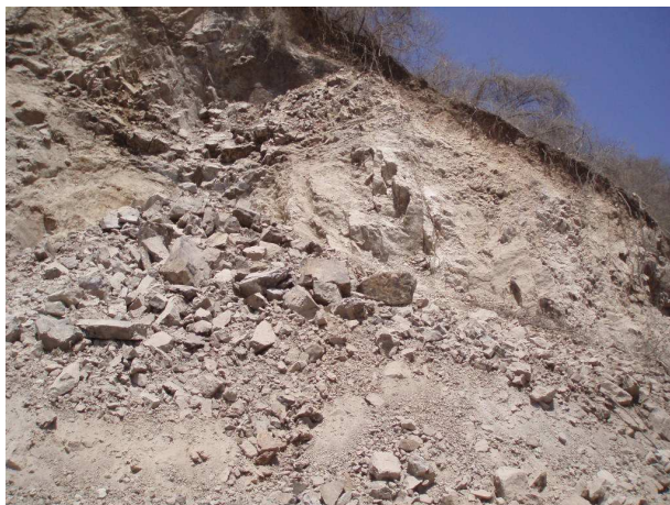
Figura V - 2 Material de banco extraído con ayuda de voladuras.
