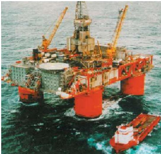
Figura 1.17 Plataforma de perforación semisumergible.
