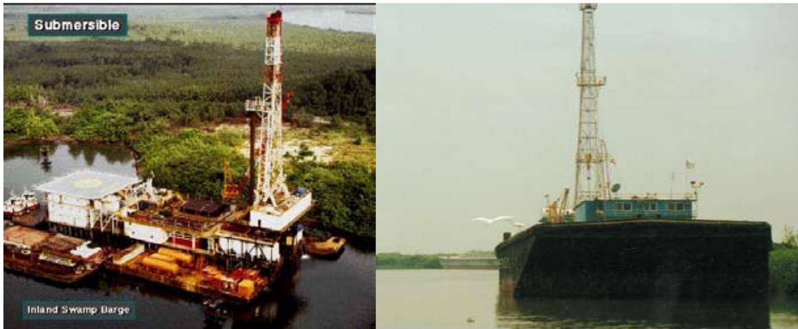
Figura 1.12 Equipos de perforación tipo Barcaza.
