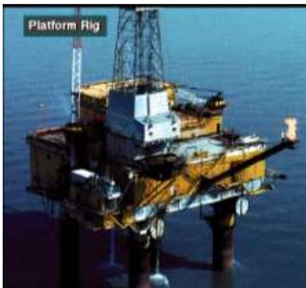
Figura 1.9 Plataforma de perforación fija de 4 piernas (Tetrápodo).
