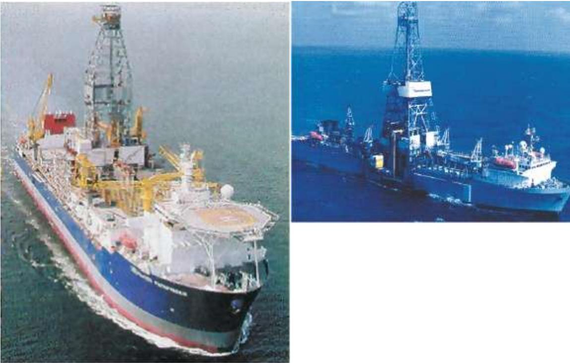
Figura 1.18 Barco de perforación
