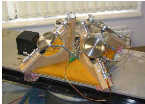
Figura 2.4 Prototipo de sistema de estabilización satelital por CMGs desarrollado en Surrey, Inglaterra
