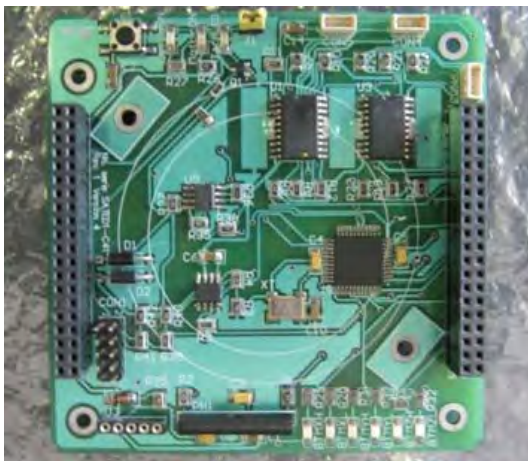
Figura 5.45 Ensamblado del circuito impreso de estabilización activa
