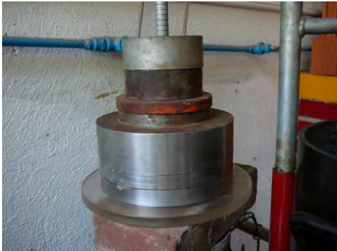
Fig. 4.7 Contrapeso VeBe de 22.7 kg
