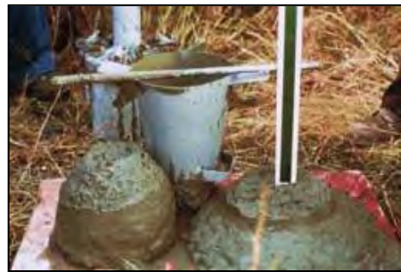
Fig. 3.2 Prueba de revenimiento.
