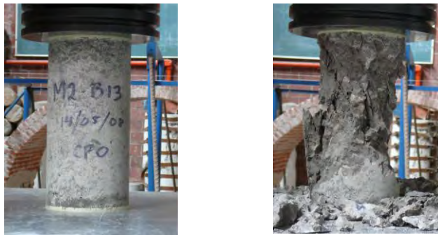
Fig. 5.8 Especímenes de CCR de 15 X 30 cm ensayados a compresión simple
