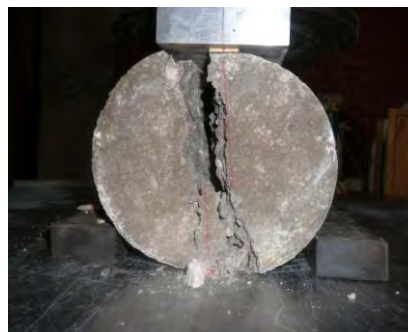
Fig. 5.21 Falla de cilindro ensayada a tensión indirecta.
