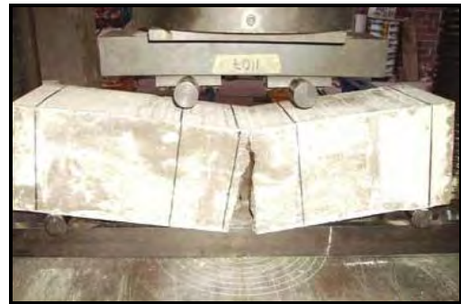
Fig. 5.27 Viga ensayada fallando en su tercio medio trazado
