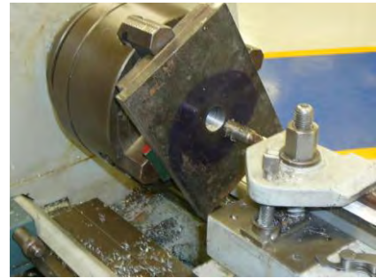
Fig. 4.16 Elaboración de cuerda hembra en la placa rectangular.
