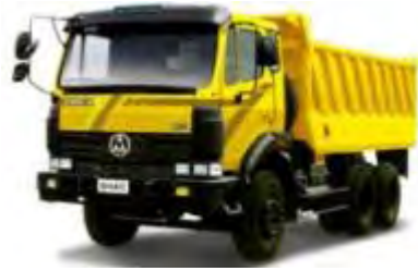
6.6 Vehículo común para transportar el CCR en presas
