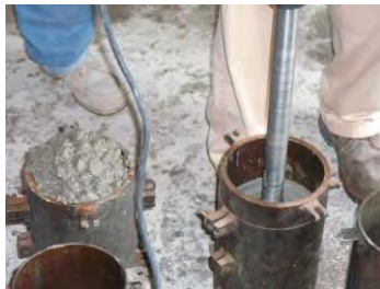
Fig. 4.21 Compactación de capas de CCR en moldes cilíndricos
