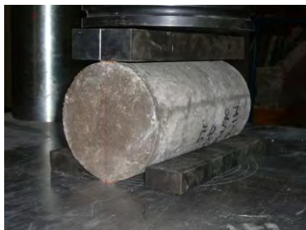
Fig. 5.20 Ensayo a tensión indirecta de cilindro de concreto en laboratorio.
