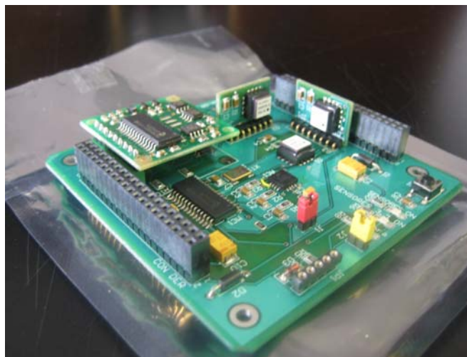
Figura 2.7 Subsistema de sensores.
