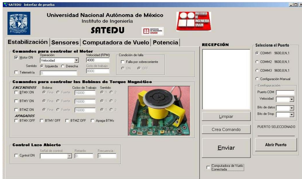
Figura 2.8 Software de estación terrestre.
