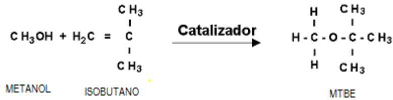
**Fig. 1. Reacción Metanol-Isobuteno-MTBE**
