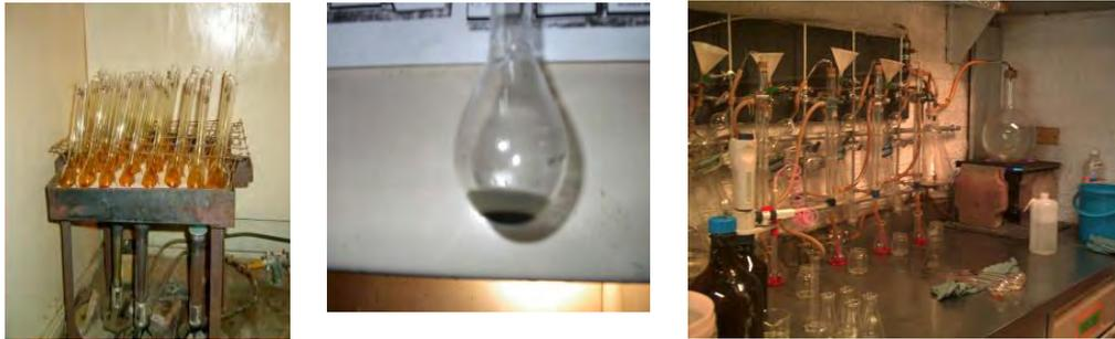
Figura 21. Nitrógeno por semimicro-kjeldahl con inclusión de nitratos.
