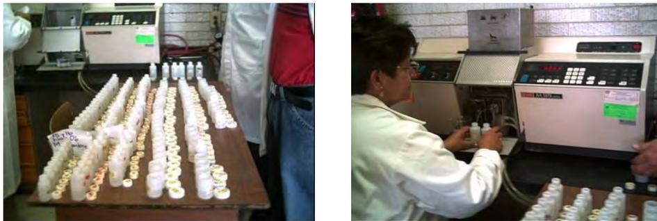
Figura 22. Extracción de cationes intercambiables del suelo
