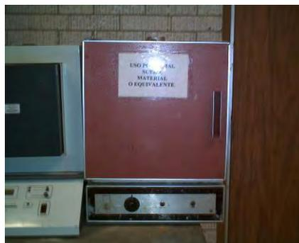
Figura 12. Estufa para secado de muestras
