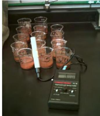
Figura 18. Determinación de conductividad eléctrica
