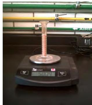
Figura 19. Determinación de densidad, técnica de la probeta.
