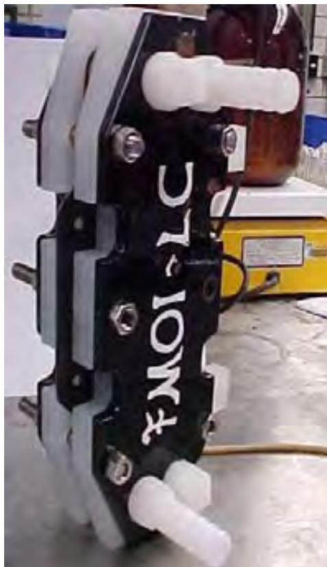
Figura 2.2. (a) Vista vertical del reactor electroquímico FM01-LC utilizado para realizar las pruebas de macroelectrólisis, (b) componentes del reactor.
