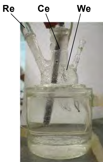
Figura 2.1. Celda típica de 3 electrodos empleada para las electrólisis, Re es el electrodo de referencia ( \text{Hg}/\text{Hg}_2\text{SO}_4/\text{K}_2\text{SO}_4 ), Ce contraelectrodo (ánodo de grafito) y We electrodo de trabajo (electrodo DSA).
