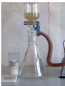
Figura 3.7 Equipo de Filtración de solventes en el HPLC
