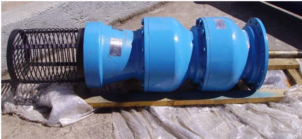
Fig. 1.2.2 Bomba vertical de dos impulsores de 350 hp.
