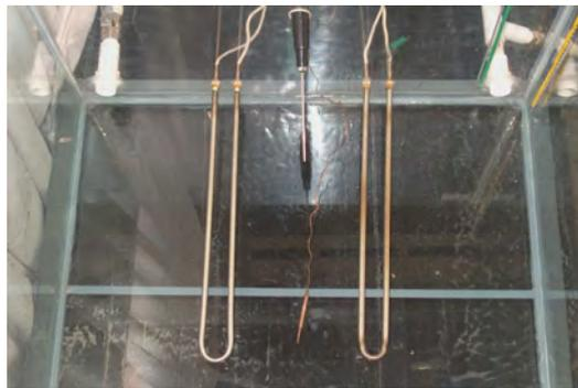
**Figura 26.** Resistencias eléctricas para el calentamiento del agua
