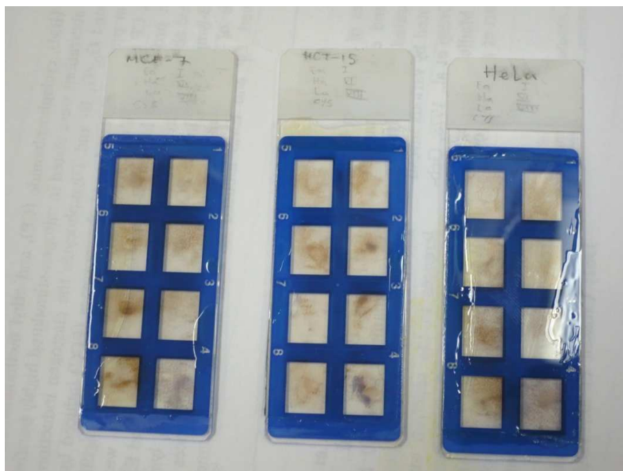
Fig.13. 3 Portaobjetos de 8 pozos cada uno, en 6 pozos las distintas Casiopeínas ® , uno con CDDP y un control negativo sin tratamiento.
