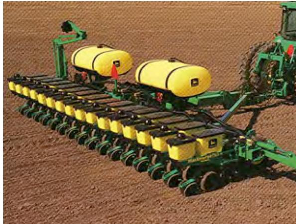
**Figura 6. Sembradora-fertilizadora múltiple de tiro (Agleader, 2006).**
