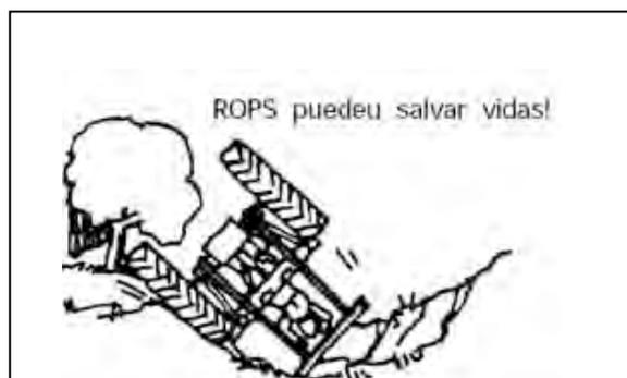
**Figura 10. Los ROPS (Rollover Protective Structures) o estructura de protección de volcamiento protegen la vida del tractorista (NASD. 2004).**
