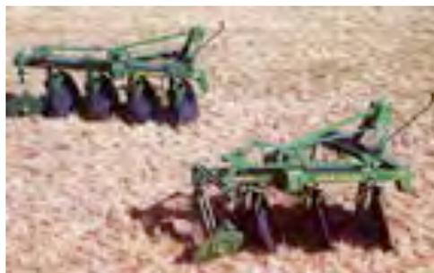
**Figura 4. Arados de tres y cuatro discos de enganche integral (Deere and Co, 2007)**
