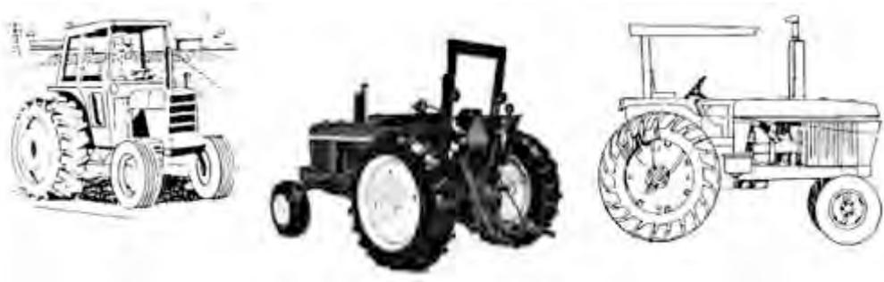
**Figura 11. ROPS y cabinas de protección en los tractores protegen y dan confort a los tractoristas.**
