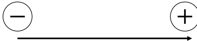
Figura 1.1 En la presente figura se puede apreciar el sentido en que se mueven los electrones en un circuito alimentado por corriente directa.
