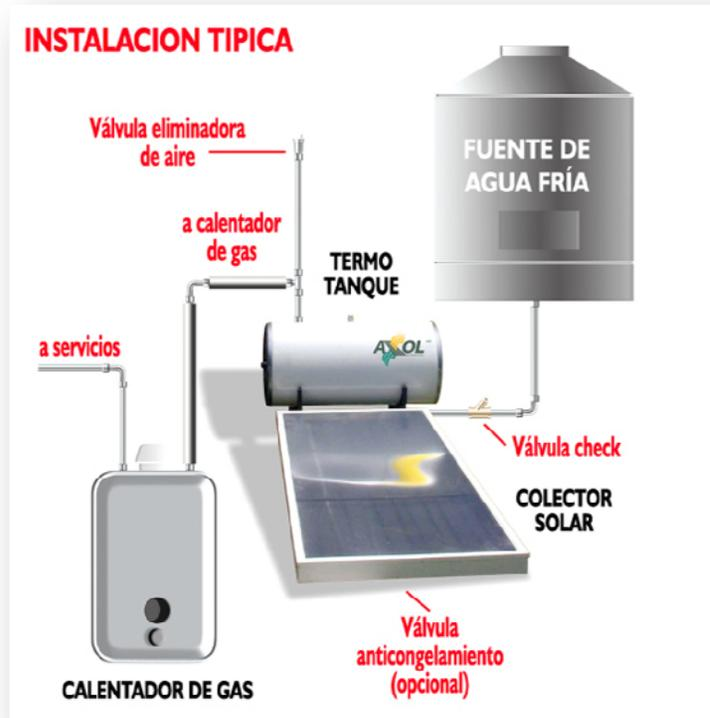
Diagrama de Instalación del calentador Solar.
