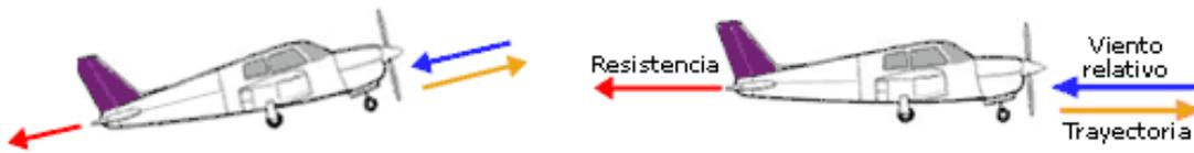
Fig. 3.10 Dirección y sentido de la resistencia
