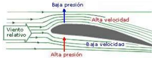
Fig. 2.7 Presión del aire vs velocidad
