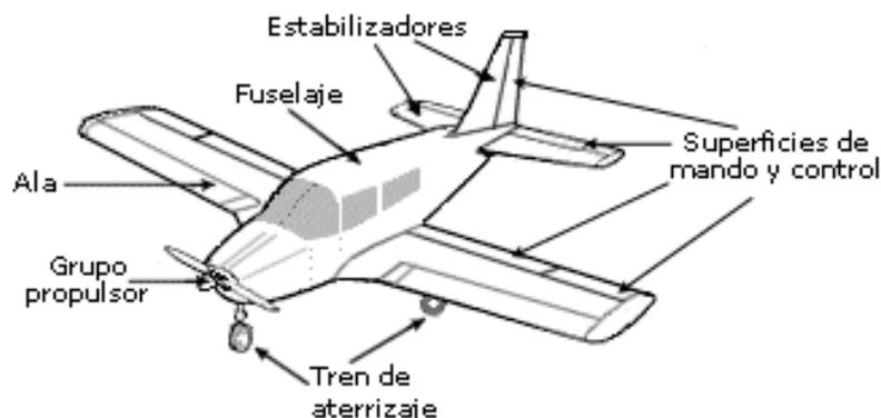
Fig. 2.4 Estructura básica de una aeronave
