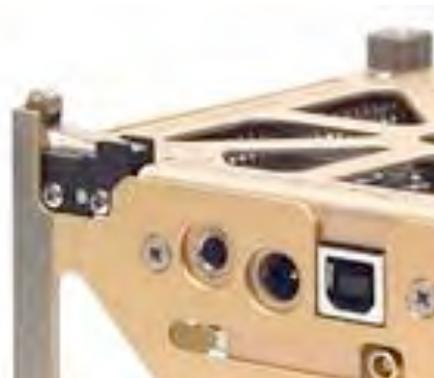
Figura 22. Detalle de la ubicación del interruptor de despliegue.
