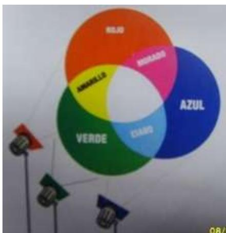
Fig.23 Sistema aditivo de colores primarios de luces. La superposición de los colores primarios origina todos los demás colores, y la luz blanca con todas las longitudes de onda al centro.<sup>2</sup>
