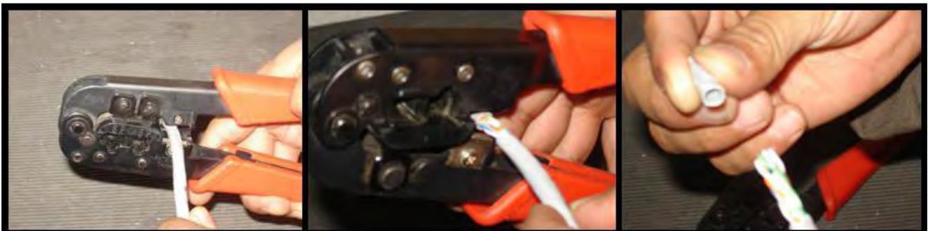
**Figura 1.** En esta imagen se muestra la eliminación del forro.
