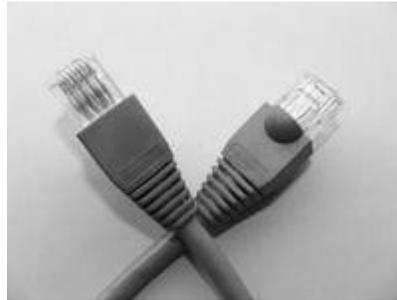
**Figura 1.8 Conectores RJ-45**
