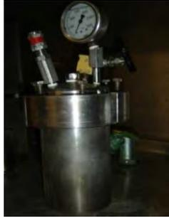
**Figura 10.** Autoclave utilizada en el método solvotérmico
